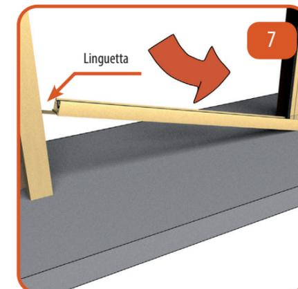
Inserire la linguetta spigi profilo all'estremità della guida inferiore e posizionarla a terra inserendola nell'aletta della testata.
