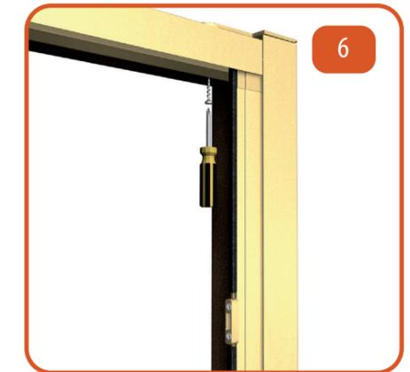
Fissare la guida superiore alla testata, inserendo la vite nel foro della guida.
