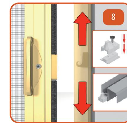
Inserire la base del gancio nella parte inferiore della "U", regolare la altezza, dopodiché appoggiare sulla base il gancio e avvitarlo, in modo tale da bloccarlo con la vite.
