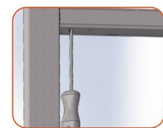
Per regolare la carica di ritorno nella zanzariera sarà sufficiente inserire il cacciavite con la testa esagonale nel foro situato sul lato inferiore della guida superiore (lato cassonetto) ed agire in senso orario o antiorario per caricare o scaricare la molla.
